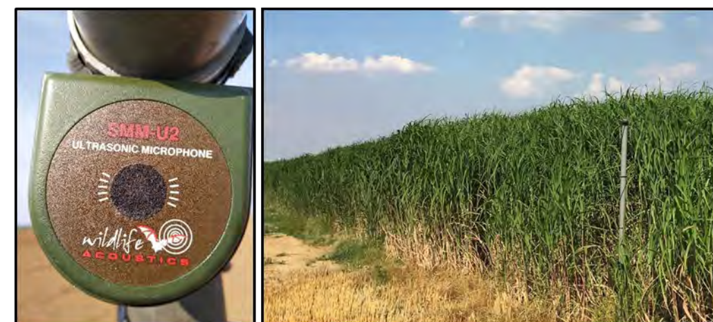
FIGURE 62- ENREGISTREUR SM4BAT FS AVEC UN MICRO SMM-U2 EN CONFIGURATION D'ECOUTE SEMI-PASSIVE SUR PERCHE DE 2M AU NIVEAU DU POINT D'ECOUTE C4 (SOURCE : ING ENVIRONNEMENT)
