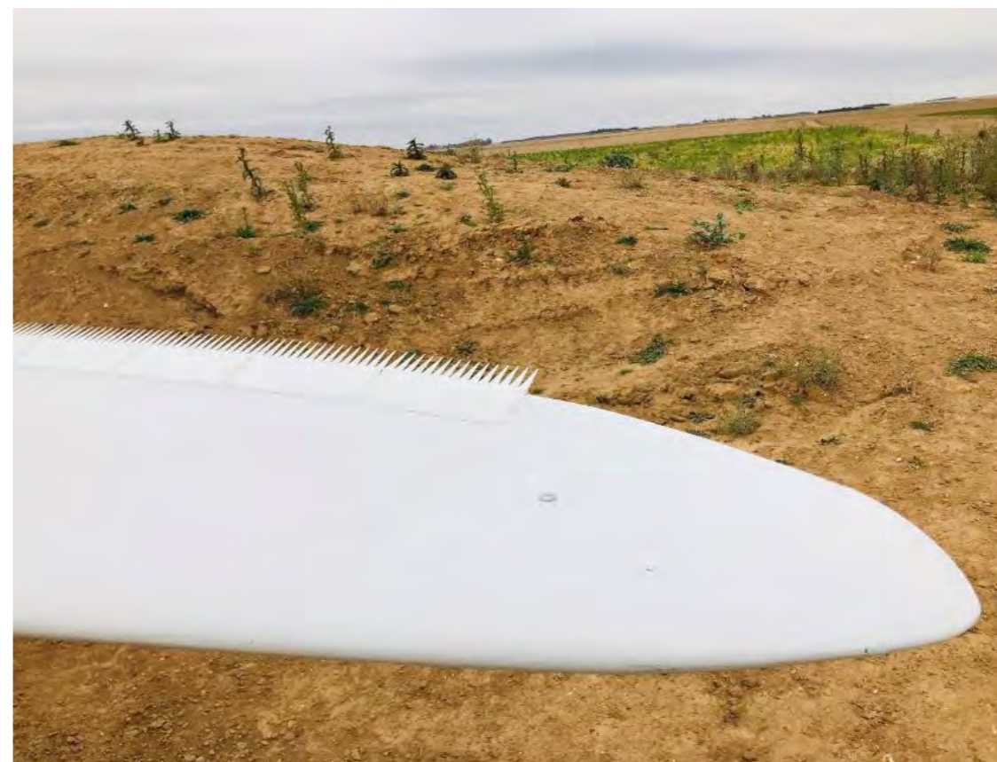
FIGURE 31 – PALE EQUIPEE D'UN SYSTEME DE SERRATIONS - (SOURCES : ING ENVIRONNEMENT)
