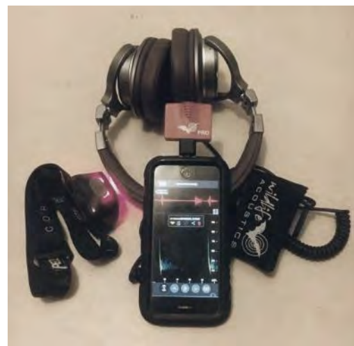
FIGURE 60 – CAMERA ENDOSCOPIQUE ET DETECTEUR ET ENREGISTREUR WILDLIFE ECHOMETER PRO, UTILISE POUR LES INSPECTIONS ET LES SORTIES DE GITES (SOURCE : ING ENVIRONNEMENT).
